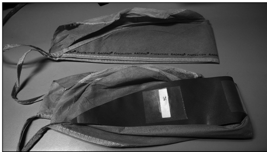
Figura 2. Disposición de un dosímetro colocado en la parte externa de la lámina de tungsteno-bismuto a nivel temporo-parietal derecho. El segundo dosímetro queda oculto en la imagen, pero está a la misma altura por la parte interna de la lámina (Fuente: elaboración propia).
